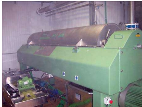
Separador por centrifugación o sistema continuo.
