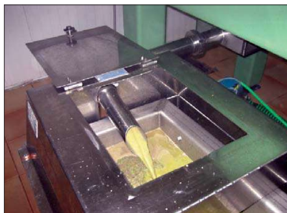
Obtención de la fase oleosa después del proceso de separación y anterior al decantado.
